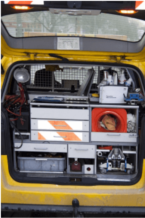
Der 12-180/15 von Airpress ist besonders geeignet für den Fahrzeugeinbau.
